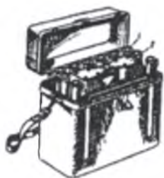
Іл. 34.7. Комплект ІД-1: 1 — індивідуальний дозиметр; 2 — зарядний пристрій
