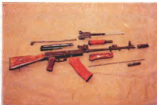
Іл. 12.12. Вигляд автомата, його механізмів та деталей після неповного розбирання
