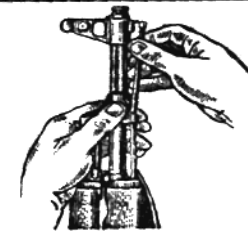
Мал. 30. Відокремлення шомпола
