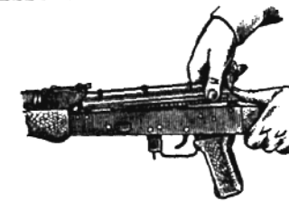
Мал. 31. Відокремлення кришки ствольної коробки
