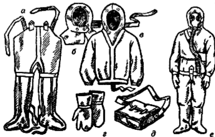
Мал. 150. Легкий захисний костюм Л-1: а - штани з панчохами; б - підшоломник; в - сорочка з капюшоном; г - двопальцеві рукавиці; д - сумка для зберігання костюма; е - одягнений Л-1
