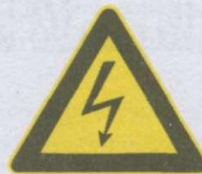
Іл. 44.14. Знак «Небезпека ураження електричним струмом»
