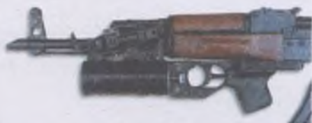
Іл. 12.13. АК-74, Місце для кріплення підствольного гранатомета
