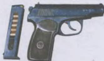
Іл. 12.17. Пістолет ПМ (загальний вигляд)
